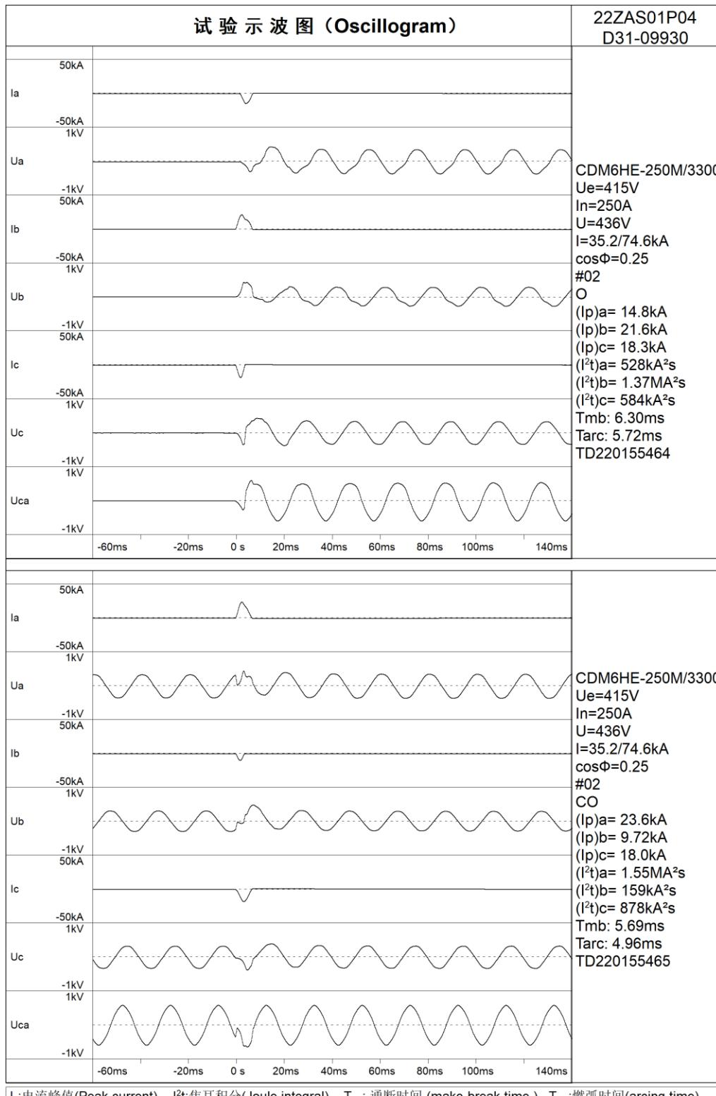
$I_p$ : 电流峰值(Peak current)  $I^2t$ : 焦耳积分(Joule integral)  $T_{mb}$ : 通断时间 (make-break time)  $T_{arc}$ : 燃弧时间(arcing time)
